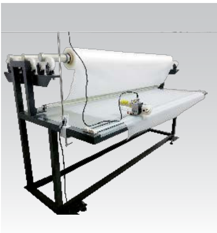
Portarrollos eléctrico con cortador guiado / Electrical EVA dispenser with guided cutter
